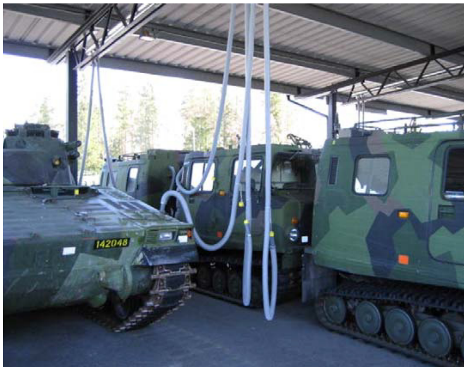
Bild 3. Skärmtak med objektvis avfuktning
